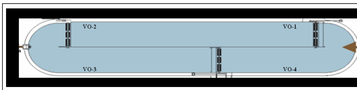
Figura 1: desenho esquemático do Valo de oxidação, com indicação dos aeradores (A1, A2 e A3) bem como os pontos de coletas (VO-1, VO-2, VO-3, VO-4 e VO-Saída).
